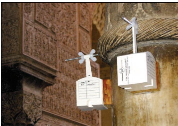
Pour mesurer l'évolution du glissement du chapiteau sur la colonne, 2 jauges G3 sont posées sur la colonne, décalées de 90°
