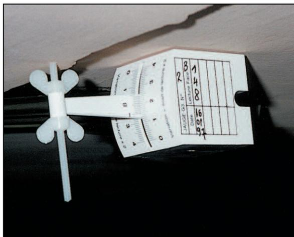
Un auto-adhésif double face, livré avec la jauge permet de réaliser une pose satisfaisante. Ci-dessus, jauge G3 posée en plafond.
