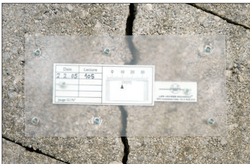
Résultat de la pose avec tap-vis
