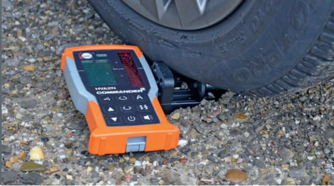
Le récepteur laser **COMMANDER 2** sont équipés de série du support de récepteur «Heavy-Duty» en aluminium moulé sous pression qui est pratiquement indestructible.
