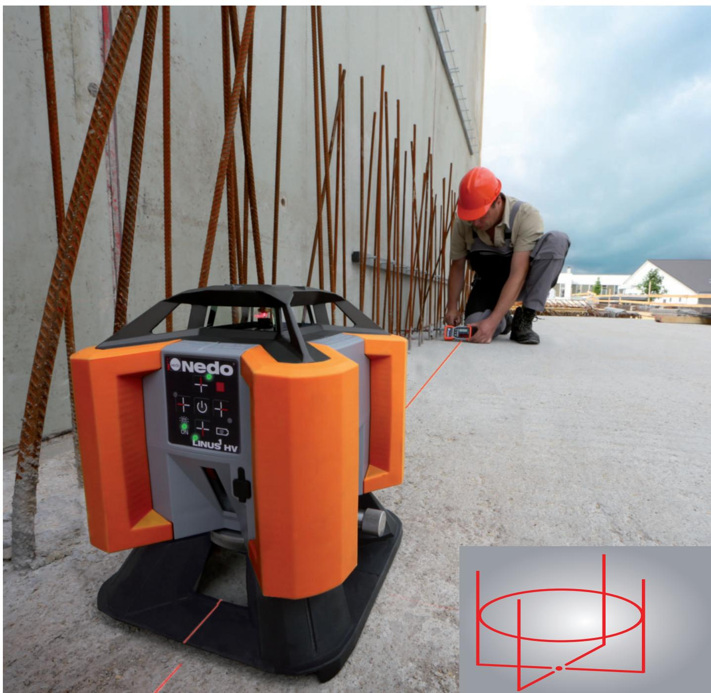
Les dimensions du laser et du récepteur laser ACCEPTOR Line sont parfaitement harmonisées. La distance entre le plan vertical du laser et le bord du boîtier du **LINUS 1 HV** et la distance du bord du boîtier à la ligne zéro du récepteur laser sont identiques. De ce fait, l'orthogonalité de surfaces de murs ou de coffrages peut être facilement vérifiée. Des écarts de mesure peuvent être lus directement au mm près sur le récepteur laser numérique ACCEPTOR Line.
